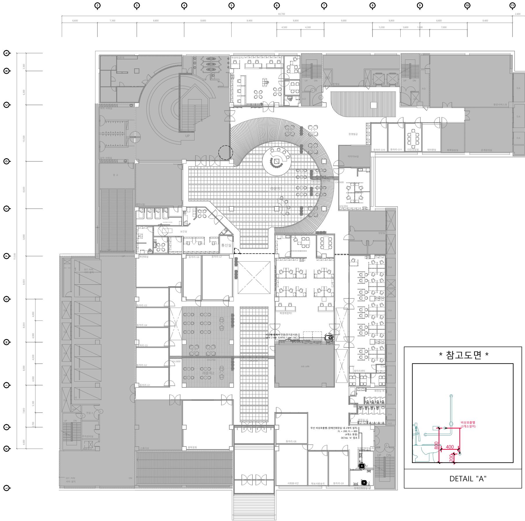
지하1층 비상벨설비 평면도(변경후) SCALE(A1) : 1 / 200 SCALE(A3) : 1 / 400
